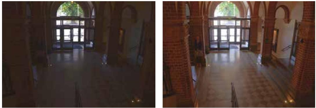
그림 7 및 8: 다른 dB 값의 카메라로 캡처한 역광 상태 실내. 예상과 달리 오른쪽 이미지가 왼쪽 이미지보다 지정된 dB 값이 낮은 카메라로 촬영한 이미지입니다.
