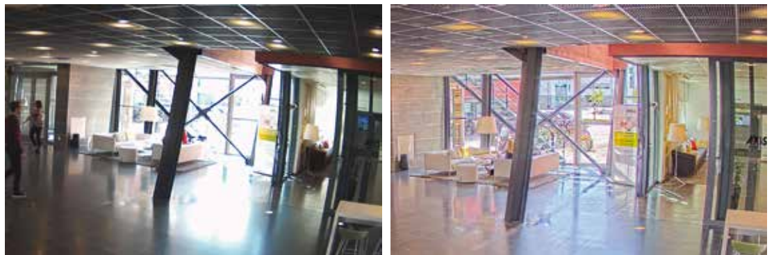
画像5、6:強い逆光がある屋内シーン。WDR機能を搭載しない従来のネットワークカメラ（左側）とアクシスのForensic WDR搭載カメラ（右側）で撮影した画像の比較。
