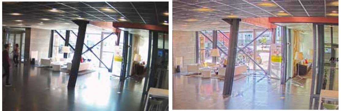
Abbildung 5 und 6: Innenraumszene mit starker Hintergrundbeleuchtung. Vergleich zwischen einer herkömmlichen Netzwerk-Kamera ohne WDR-Funktion (links) und einer Axis-Kamera mit Forensic WDR (rechts).
