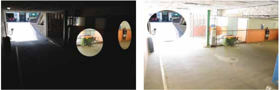
Abbildung 3 und 4: Die gleiche Szene wie oben. Im linken Bild die Details, die bei kurzer Belichtungszeit nicht erkannt wurden. Im rechten Bild die Details, die bei langer Belichtungszeit nicht erkannt wurden.
