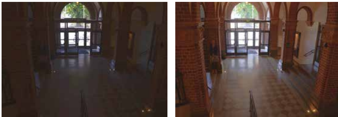
Figures 7 et 8 : Intérieur capturé en contre-jour par des caméras dont les valeurs en dB diffèrent. L'image de droite a été prise avec une caméra dont la valeur en dB est plus faible que pour l'image de gauche, contrairement à ce qu'on pourrait croire.
