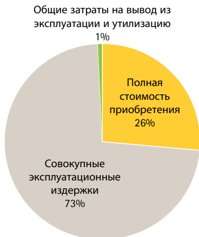
Рис. 7. Долевое распределение затрат на протяжении жизненного цикла с учетом расходов на персонал оперативного центра.
