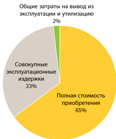
Рис. 6. Долевое распределение затрат на протяжении жизненного цикла с учетом издержек из-за непредвиденных простоев.
