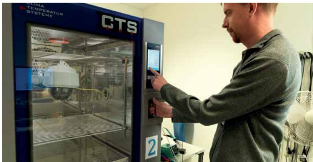
图5：人工气候室中的温度测试。
