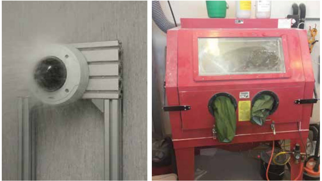
图3：左：摄像机防水测试，右：粉尘实验室。
