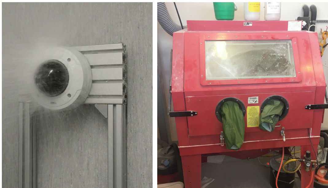
Рис. 3. Слева: испытание камеры на водонепроницаемость; справа: пылевая камера.
