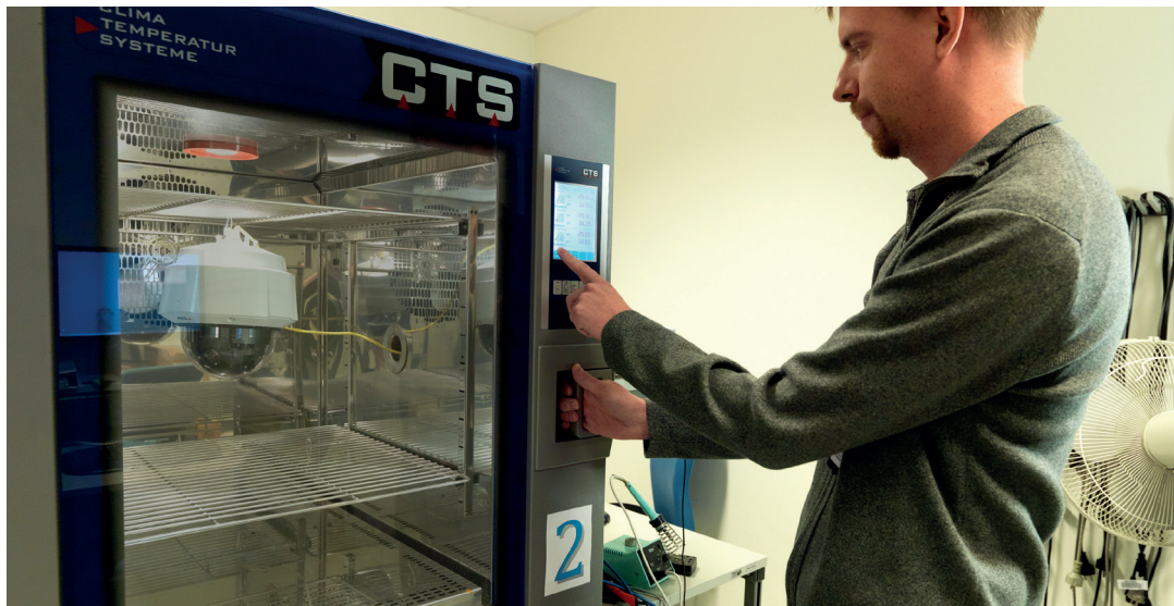
Рис. 5. Температурные испытания в климатической камере.
