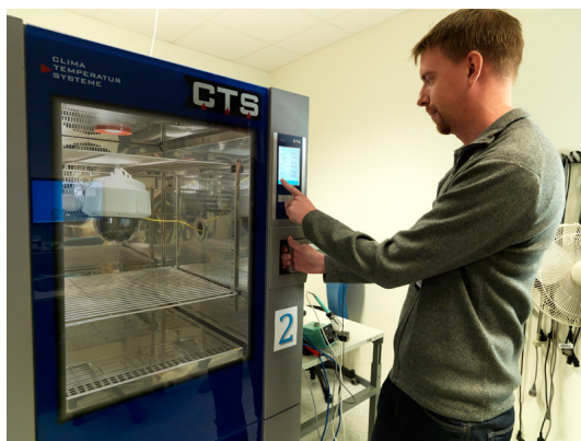
Figure 6. Prova di temperatura in camera climatica.
