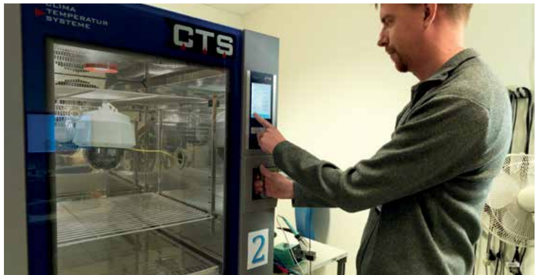
Figura 5: Prueba de temperatura en una cámara climática.
