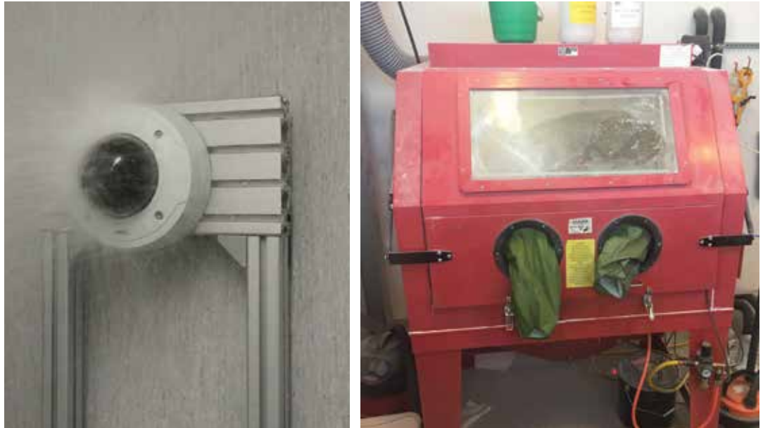
Figura 3: teste de resistência à água de uma câmera. À direita, um laboratório para testes de poeira.
