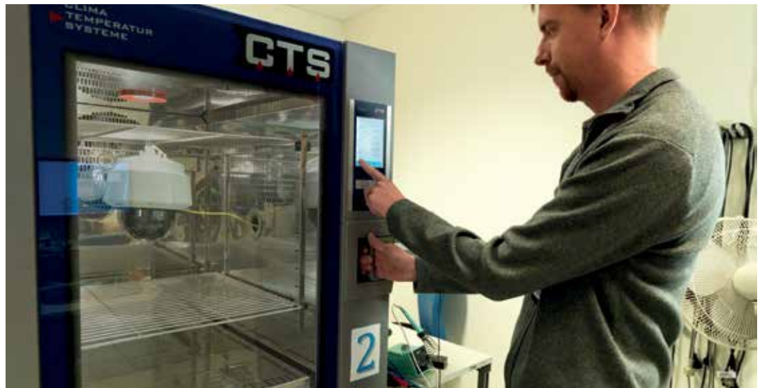
Figura 5: teste de temperatura em uma câmara climática.
