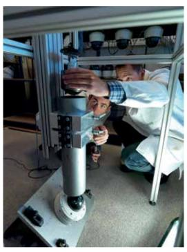
図3: カメラの衝撃試験
