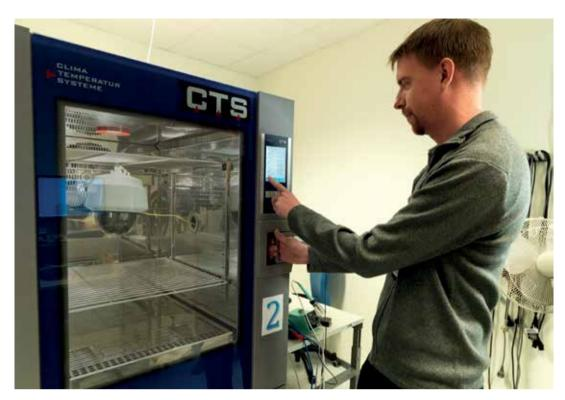
図8: 人工気候室で行う温度試験
