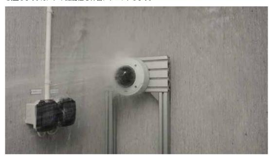
図4: カメラの防水性試験
