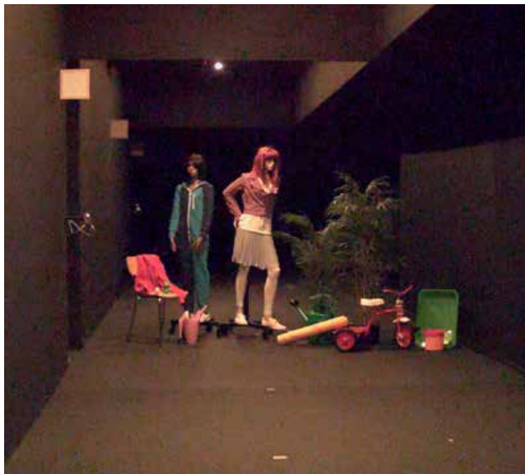
图 6: 物体上测得的照度为 0.1 lux - 0.3 lux。“觅光者”摄像机提供的彩色图像清晰度有所下降,但细节仍然非常丰富。人眼无法辨认较暗表面,无法感知细节或色彩。
