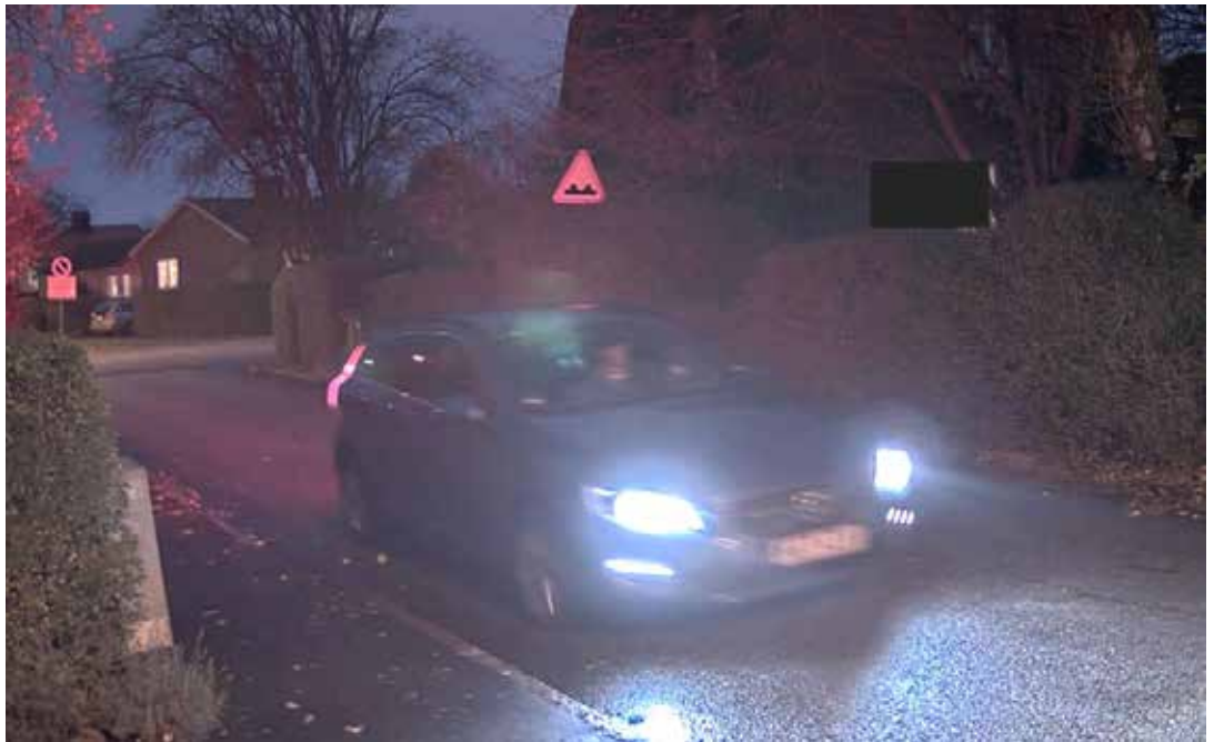
Figura 8: um longo tempo de exposição pode causar um borrão visível. Neste instantâneo de vídeo, a placa de licença poderia estar legível se um tempo de exposição menor tivesse sido usado.
