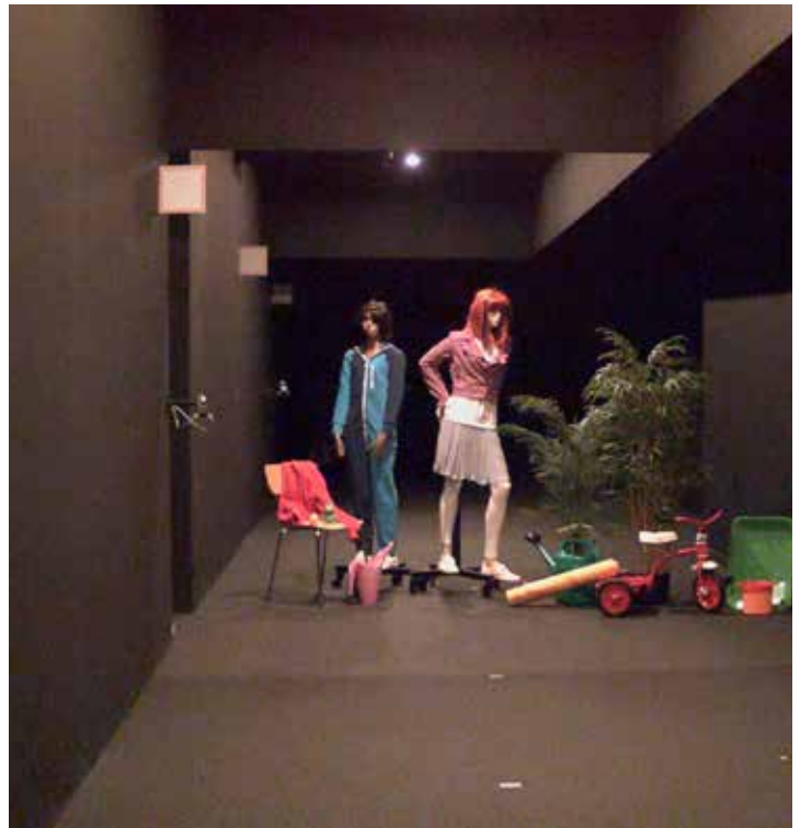
Figura 5: 0,2 lux - 0,7 lux medidos nos objetos. A câmera com Lightfinder fornece cores brilhantes. Para um olho humano, a visão em cores era questionável e as principais superfícies claras podiam ser discernidas, com muito poucos detalhes.
