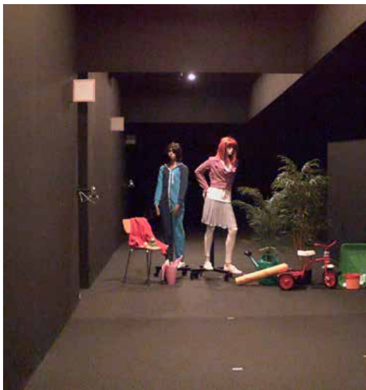
Рис. 5: Освещенность, измеренная у объектов, составляет 0,2 люкс - 0,7 люкс. Камера с технологией Lightfinder дает яркое цветное изображение. Для человеческого глаза возможность различить цвета под сомнением, видны лишь светлые поверхности с очень плохой детализацией.
