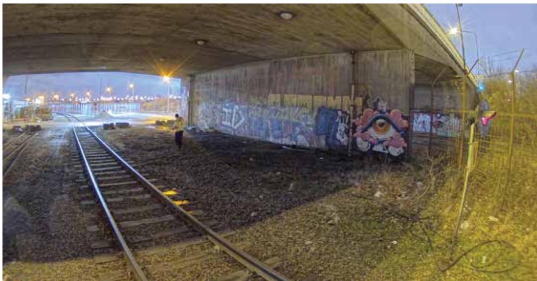
Рис. 9: Камера с технологией Lightfinder 2.0 дает четкое яркое цветное изображение несмотря на то, что освещенность под мостом составляет всего 0,05 люкс.
