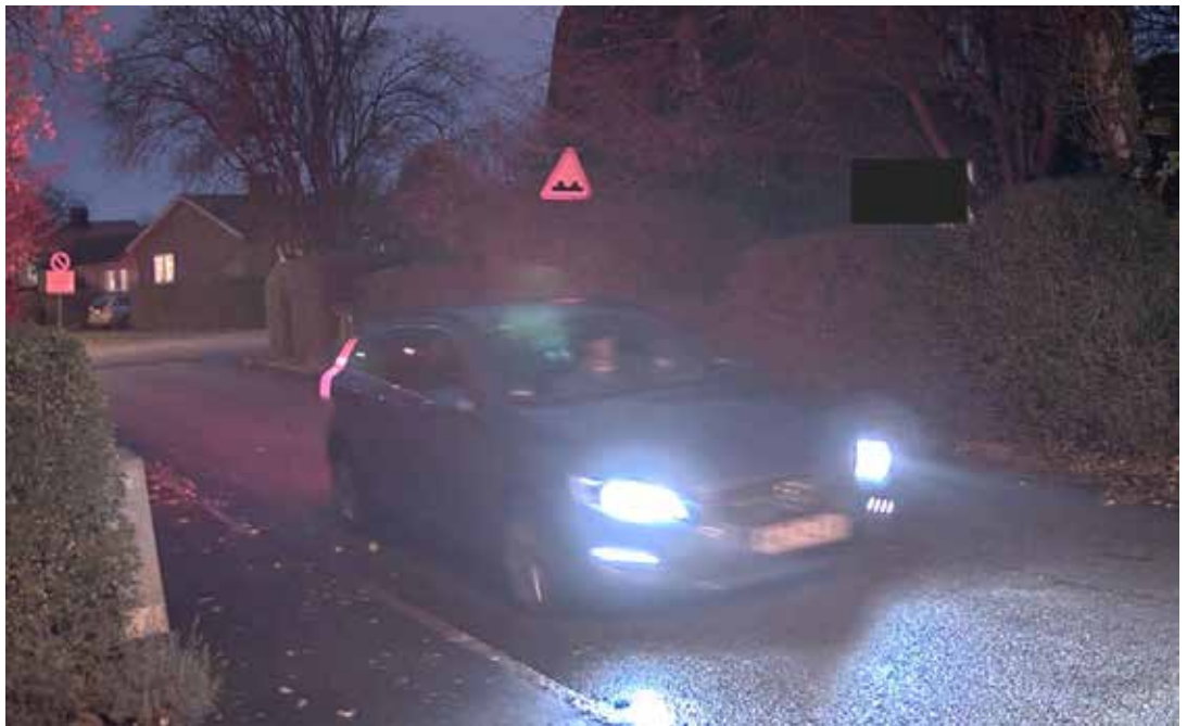
Рис. 8: Длительная выдержка может привести к заметному размытию движущихся объектов. На этом стоп-кадре из видео номерной знак мог бы читаться, если бы использовалась более короткая выдержка.
