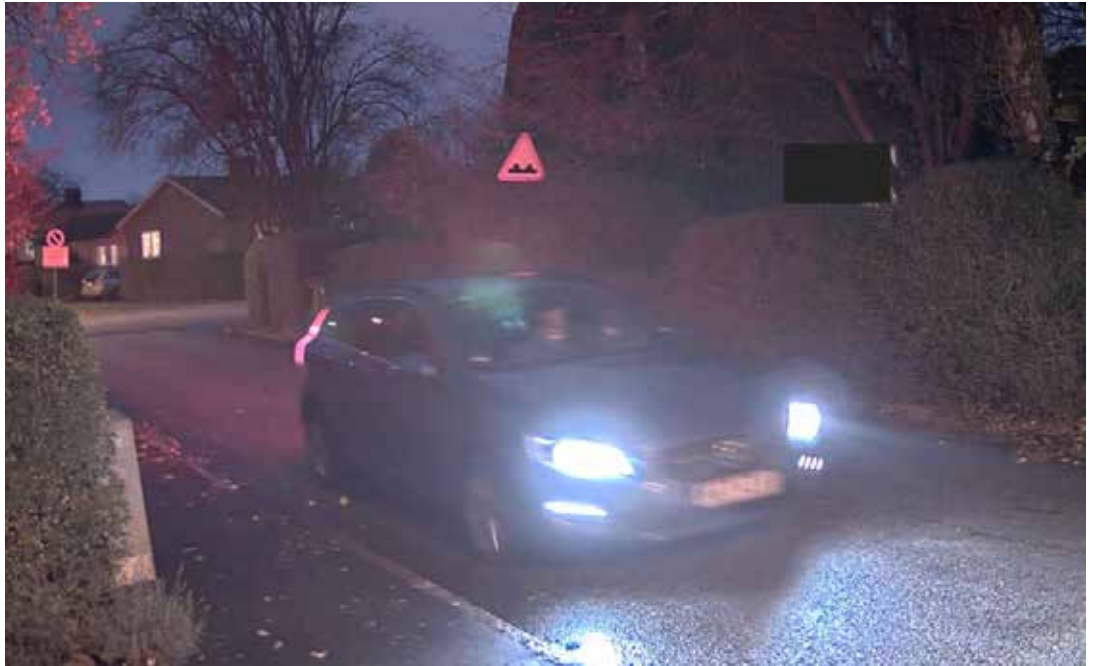
Figura 8: un tempo di esposizione lungo può causare una sfocatura da movimento visibile. In questo video, la targa sarebbe stata leggibile con un tempo di esposizione breve.
