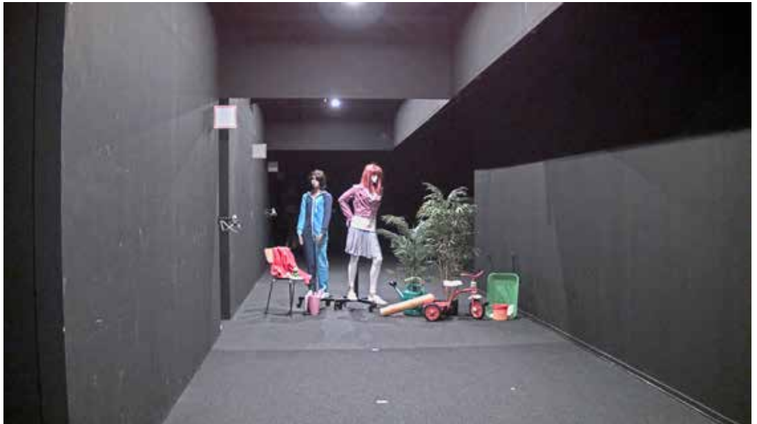
Abbildung 4: Eine Studioszene mit einer Lichtstärke zwischen 1,5 Lux (am Dreirad) und 5 Lux (an den Puppentailen). Die Kamera mit Lightfinder lieferte klare Farben und ein täuschend helles Bild, während ein menschliches Auge auch Farben unterscheiden konnte, die Szene jedoch als sehr dunkel wahrnahm.
