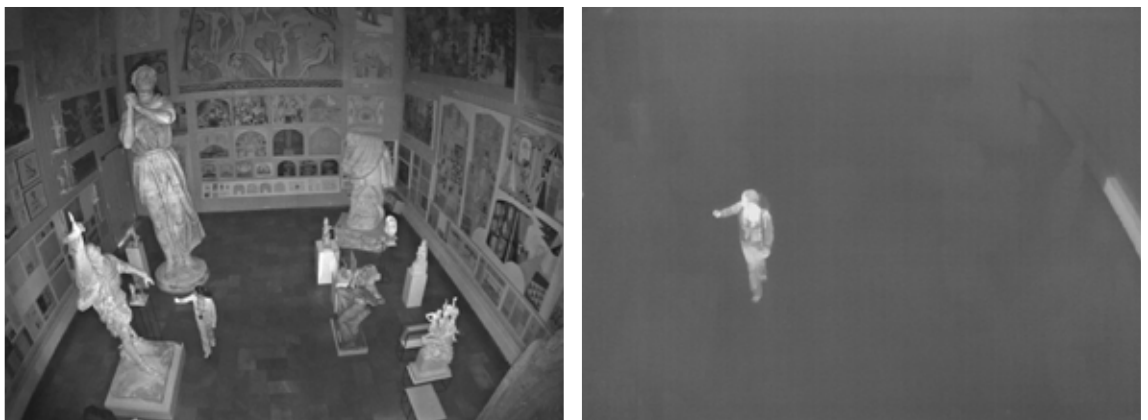
Figura 4 e 5: a sinistra, immagine di una telecamera Day&Night con illuminazione IR integrata; a destra, immagine di una telecamera termica che rileva l'irradiazione del calore in modo passivo.
