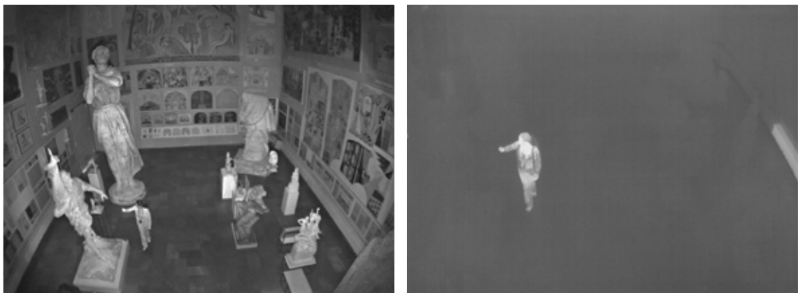
그림 4와 5: 왼쪽은 일체형 적외선 조명이 장착된 주야간 카메라 이미지, 오른쪽은 열 복사를 수동적으로 감지하는 열상 카메라 이미지.
