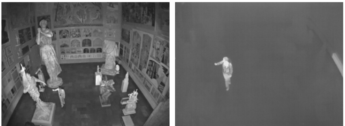
Figuras 4 y 5: a la izquierda, una imagen de una cámara día / noche con iluminación IR integrada; a la derecha, una imagen de una cámara térmica, donde se detecta la radiación térmica de forma pasiva.
