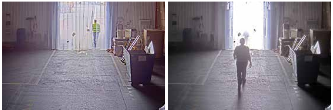
역광 환경에서도 볼 수 있는 WDR 기능을 사용한 장면(좌측)과 사용하지 않은 장면(우측).
