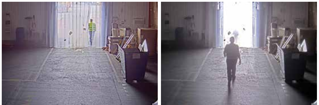
Vue en contre-jour avec WDR (à gauche) et sans WDR (à droite).
