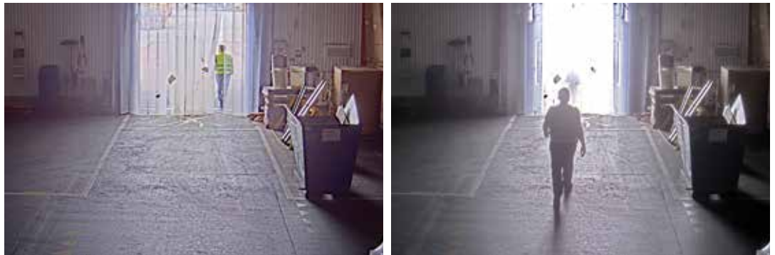
Sichtbare Aufnahmen trotz Gegenlicht mit WDR-Support (links) und ohne WDR (rechts).
