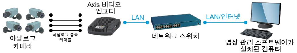
**그림 7.** 이 다이어그램은 비디오가 IP 네트워크를 통해 지속적으로 전송되는 실제 네트워크 비디오 시스템을 보여줍니다. 아날로그 보안 시스템을 개방된 IP 기반 비디오 솔루션으로 마이그레이션하는 초석으로 비디오 엔코더를 사용합니다.
