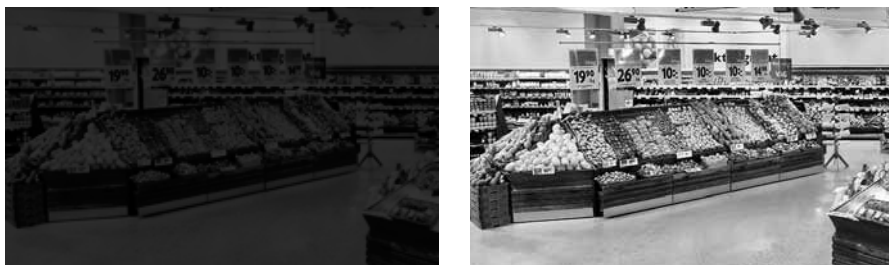
图8和图9: 图6和图7的相同图像, 只不过采用长焦镜头拍摄。左图, 物体没有得到充分的红外照明, 而右图, 红外照明均匀分布, 物体也不存在曝光不足。
