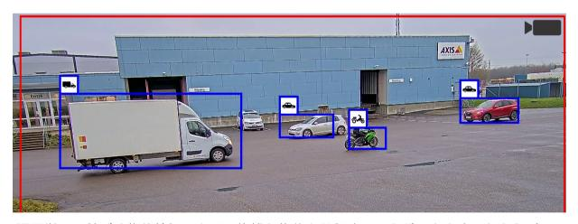
深層学習に基づく物体検知により、複雑な物体を分類することができます。たとえば、 分析アプリケーションで車両を検知できるだけでなく、車両のタイプも分類することが 可能となります。
