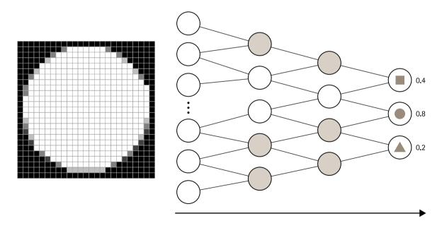
入力画像(左)とニューラルネットワーク(右)の例。出力層に到達すると、ネットワークでは、考えられる各カテゴリ(正方形、円、三角形)の確率が結論付けられます。確率値が最も高いカテゴリが、入力画像の最も可能性の高い形状となります。
