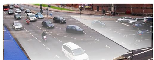
Mittels Overlays (über das Videobild gelegte Grafiken) können auch unterschiedliche Bildbereiche ausmaskiert werden.
