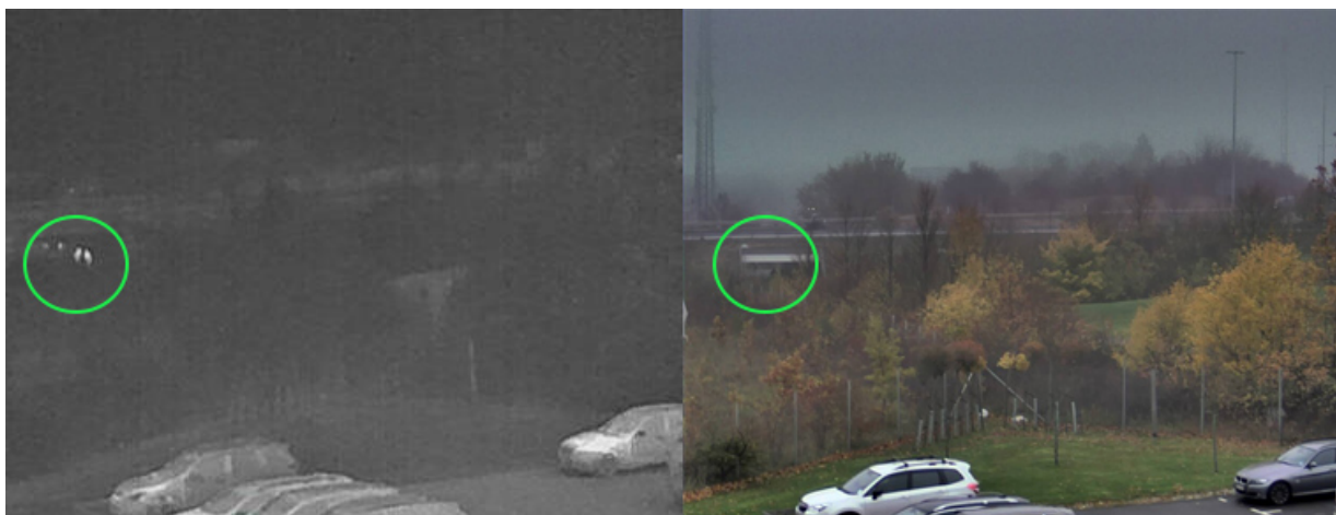
Imagens obtidas por uma câmera térmica (à esquerda) e uma câmera visual (à direita) em um dia chuvoso. Os indivíduos (circulados para referência) são facilmente distinguidos com a câmera térmica.
