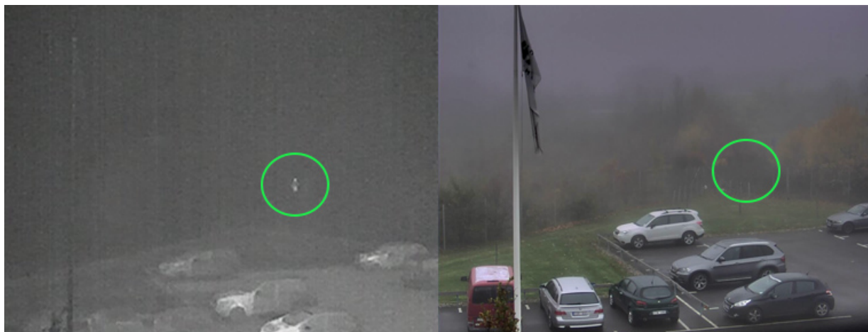
Obrazy z kamery termowizyjnej (po lewej) i kamery optycznej (po prawej) zarejestrowane w mglisty dzień. W odróżnieniu od kamery optycznej kamera termowizyjna pozwala dostrzec osobę (zaznaczoną kółkiem).
