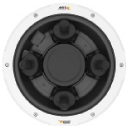
Una telecamera multidirezionale con sensori spostabili posizionati in modo equidistante, offre una completa panoramica ad un incrocio di corridoi, ad esempio.
