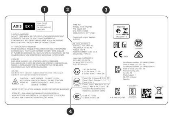
製品マーキングラベル。クラス/ディビジョンシステムに関連するマーキングを示すため にセクションが強調表示されています。
