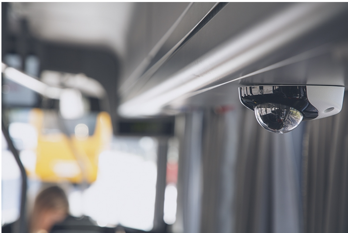
Камера с локальным хранением данных в бортовой системе видеонаблюдения.
