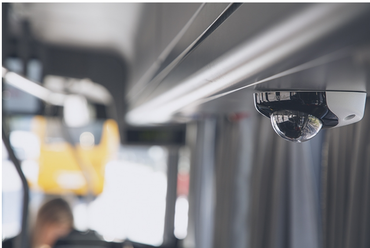
Eine Kamera mit Edge Storage in einer Onboard-Installation.
