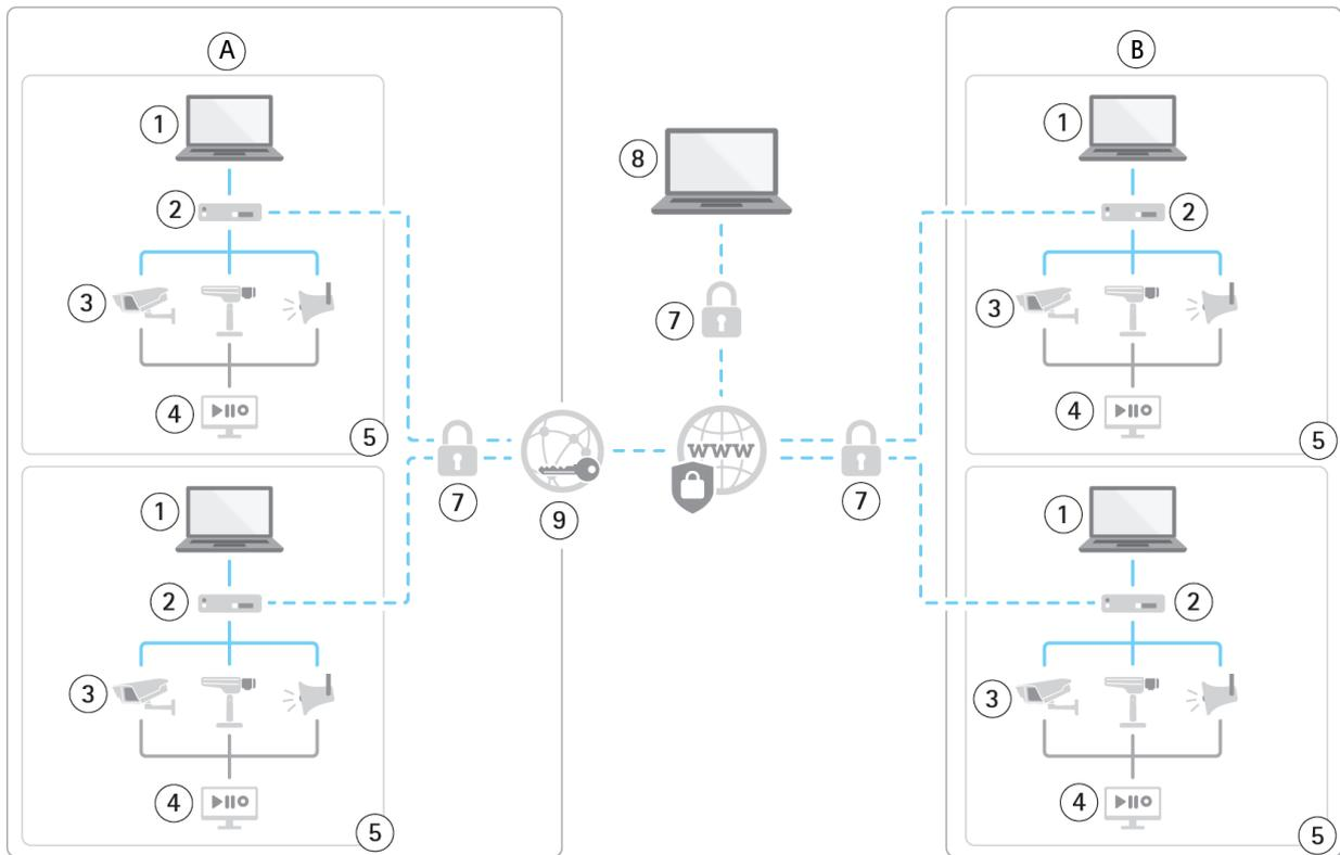
Typische Systemarchitektur mit und ohne Proxy. A: Über einen Proxy. B: Direktverbindung zum Standort
