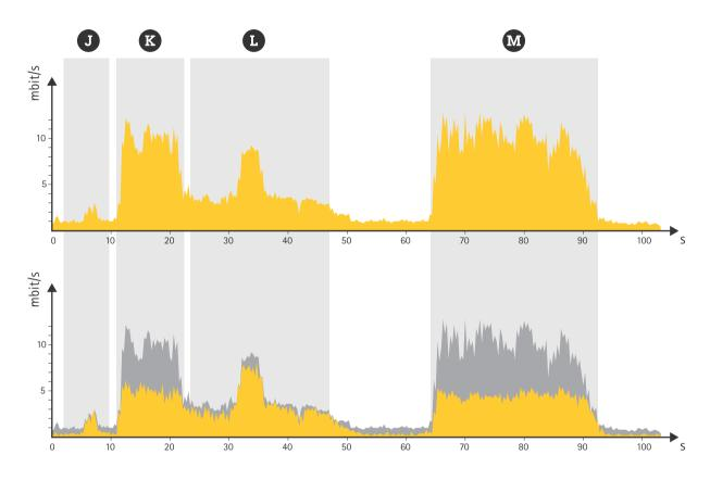
Figure 14. PTZシナリオにおける瞬時ビットレートの削減を示した図
