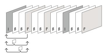
Figure 2. I、B、Pフレームを含む一般的なシーケンスの例。Pフレームは、先行するIフレームまたはPフレームだけを参照するのに対し、Bフレームは、その前後のIフレームまたはPフレームを参照する場合があります。ストレージプロファイルでは、Bフレームの数が動的に変更されます。
