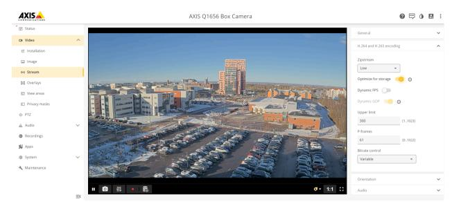
Figure 1. カメラのGUIのZipstream設定で[Optimize for storage (ストレージ用に最適化)]を選択し、ストレージプロファイルを有効にします。
