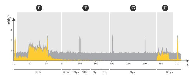
Figure 4. 4つのシナリオにおいて、ZipstreamとダイナミックFPSを有効にした場合の瞬間 ビットレートとダイナミックフレームレート
