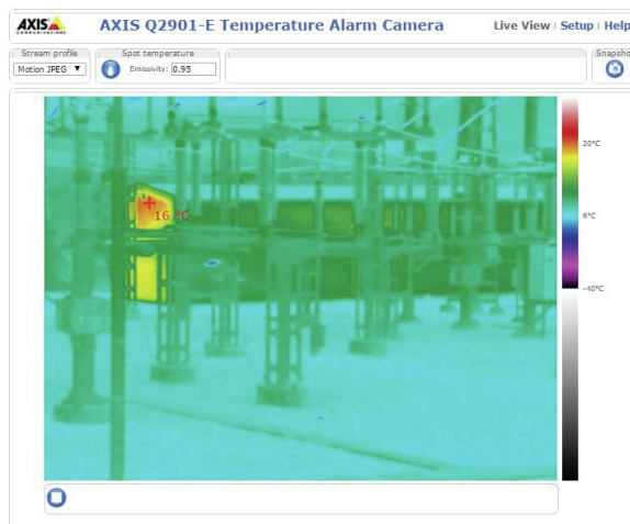
Figure 10. Скриншот с камеры с температурной сигнализацией AXIS Q2901-E. Точечная температура отображается при щелчке по желаемой области.
