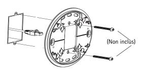
2. Fixez la caméra au support avec les 2 vis M4x8 (incluses).
