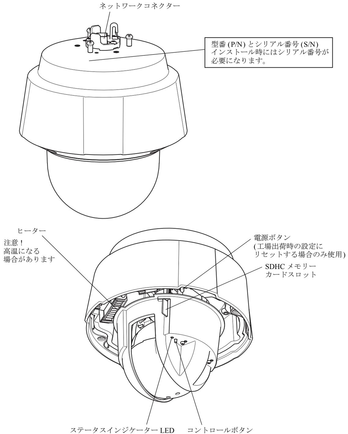
ネットワークコネクタ - RJ-45 Ethernet コネクタ。High Power over Ethernet (IEEE 802.3at) をサポートします。AXIS T8124 ミッドスパン (付属) を使用します。EMC に準拠するには、シールドケーブルを使用する必要があります。
