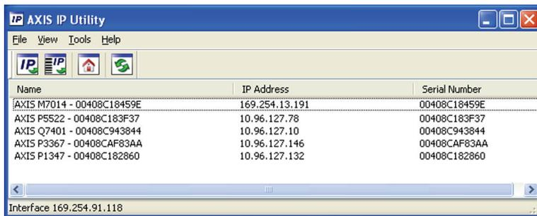
AXIS M7014/M7010 は、AXIS IP Utility が動作しているコンピューターと同じネットワークセグメント (物理サブネット) に接続されている必要があります。
