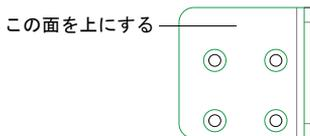
**注意：** 各ブラケットをビデオエンコーダーの適切な側面に取り付けることが必要です。このとき、壁に取り付けるかラックに取り付けるかによって、適切な角度で取り付けてください。
