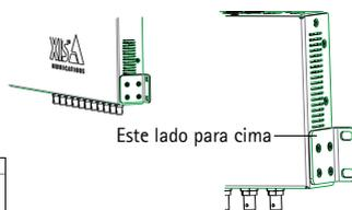
**Observação:** Cada suporte deve ser preso no lado apropriado do codificador de vídeo e em um ângulo adequado, dependendo se ele será montado na parede ou no rack.
