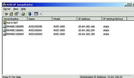
12. Fare clic sul pulsante d'opzione corrispondente alla scelta del metodo di impostazione IP effettuata (statico o dinamico con DHCP). Quando si assegna un indirizzo IP statico, è necessario definire anche la subnet mask e il gateway predefinito.
