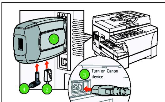
4. Collegare AXIS 1650 al connettore Ethernet utilizzando un cavo di rete. ②
