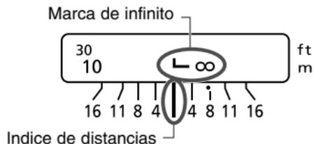
Para compensar el desplazamiento del punto de enfoque infinito que ocurre debido a cambios de temperatura.
