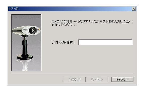
ネットワークカメラに設定されている IP アドレス、またはホスト名を入力します。 [**次へ**]をクリックします。 入力した IP アドレスが設定されているネットワークカメラの情報が表示されます。 表示する画像のサイズは、 [**解像度**]ドロップ ダウンリストから選択することができます。
