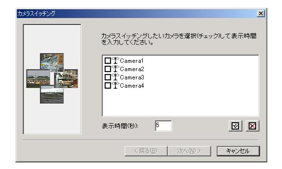
画像を表示させるネットワークカメラを選択します。画面右下にあるボタン、 をクリックするとカメラをすべて選択、 かんりょうすると選択を解除します。 [表示時間(秒)]フィールドには、個々の画像を表示させる時間を指定します。
