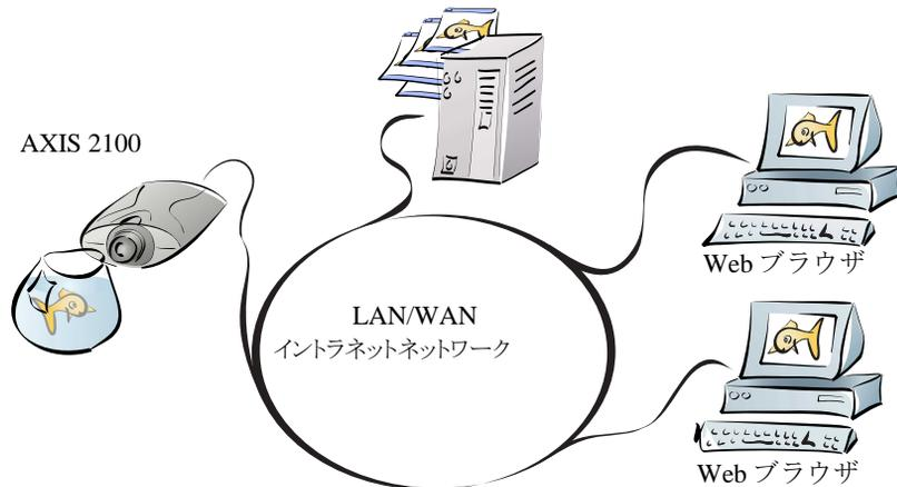
AXIS 2100 をローカルイーサネットネットワークに直接インストールします。指定した FTP サーバに連続した画像を無制限に、または指定した時間内だけアップロードするようカメラサーバを設定するには、Installation Wizard および Application Wizard を完了します。画像を取り込み、対象の FTP サーバにアップロードする時間や頻度など、指定する内容を考慮しながら設定します。
