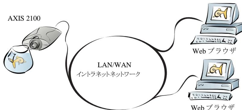
Web サイトを魅力的なものにするためにライブ画像を配信するという方法は、Web のアトラクションとしてよく使用されます。このような使用法は、ネットワークカメラ設定の最も基本的な形であり、アクセスがあまり頻繁にない大きな企業ネットワークや、SOHO (Small Office Home Office) のような小さなネットワークを導入または管理しているサイトに最適です。画像への多数のアクセスが見込まれる場合は、カメラサーバに対してネットワーク上の FTP サーバに画像をアップロードする方法を使用するよう検討してください。詳しくは、13 ページ「リモート FTP サーバに連続して画像をアップロードする」を参照してください。
