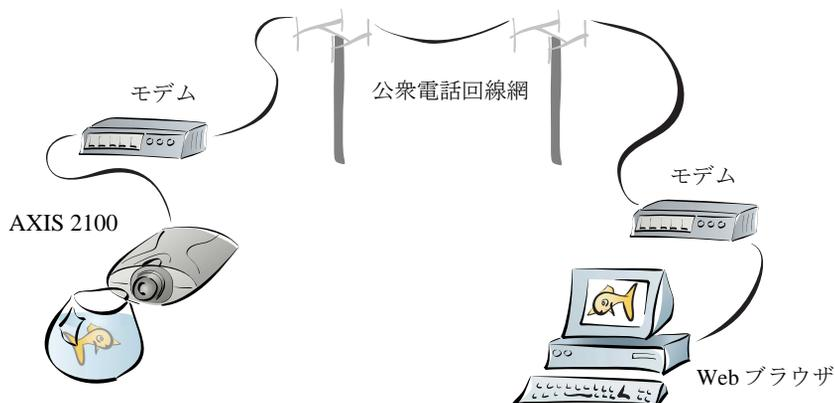
AXIS 2100 へのダイヤルアップ接続が確立すると、シリアルモデムと接続されたカメラサーバは、ユーザが作成したカスタムデザインの Web ページ上にライブ画像を配信し、素早い画像へのアクセスを提供します。ISP にダイヤルアップ接続するのと同じように、画像およびカメラサーバの Web ページにアクセスできます。
