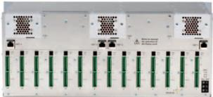
El AXIS Q7900 es un bastidor 4U de 19 pulgadas que puede albergar hasta 14 tarjetas intercambiables en funcionamiento. Las tarjetas se pueden añadir o cambiar sin tener que apagar el bastidor.
