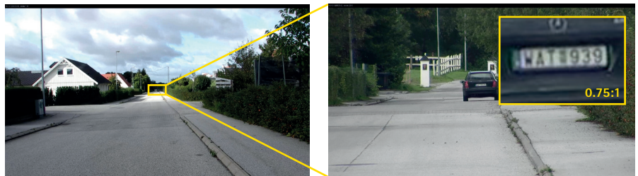
AXIS Q6035-E를 통해 275m 거리에 있는 자동차 번호판을 캡처할 수 있습니다. 왼쪽 사진은 HDTV 1080p 해상도의 전체 화면 스냅샷, 오른쪽 사진은 20배 광학줌으로 본 자동차와 번호판입니다.
