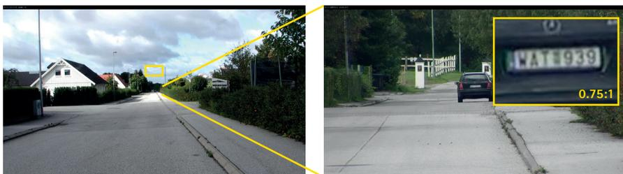
AXIS Q6035-E cattura la targa di una macchina a 275 m di distanza. A sinistra, un'immagine della visuale in HDTV 1080p; a destra, zoom ottico 20x verso una macchina con l'ingrandimento della targa.
