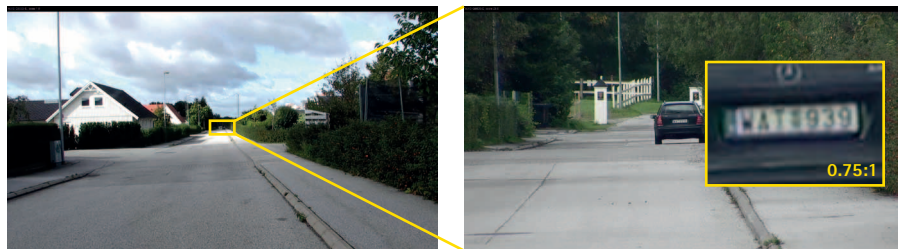
L'AXIS Q6035-E lit une plaque d'immatriculation de voiture à 275m de distance. A gauche, une capture de la vue en HDTV 1080p; à droite, un zoom optique 20x sur la plaque d'immatriculation d'une voiture.
