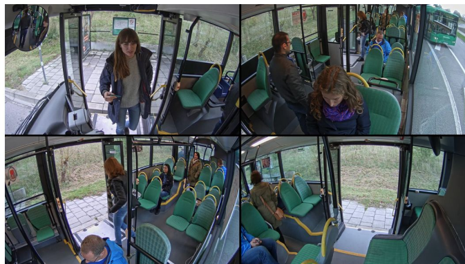
Po lewej przykład instalacji w autobusie modułu AXIS F44 (z lokalnym zapisem na kartach SD), modułów AXIS F1005-E oraz mikrofonu. Po prawej widok 4-segmentowy z autobusu.
