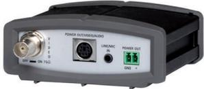
El servidor de vídeo AXIS 247S compacto resulta idóneo para su instalación cerca de la cámara analógica, donde las restricciones de espacio requieren una solución optimizada.
