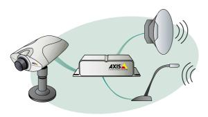
Le Module Audio AXIS 2191 permet de communiquer directement dans Internet Explorer par l'intermédiaire de microphones et de haut-parleurs, tout en fournissant des images en temps réel sur les réseaux ou l'Internet.
